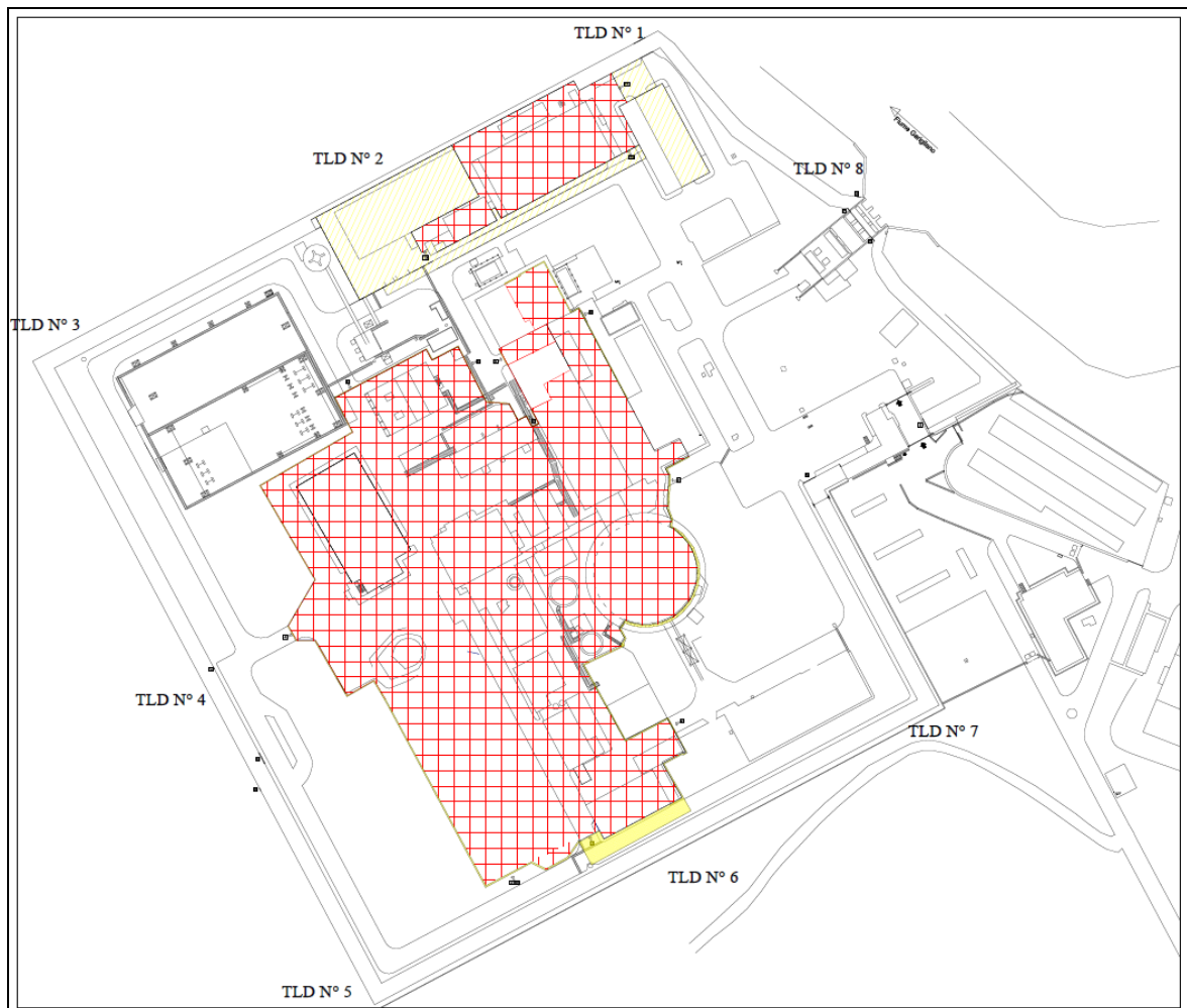
Figura n.1 - Ubicazione dosimetri - Recinzione Impianto
