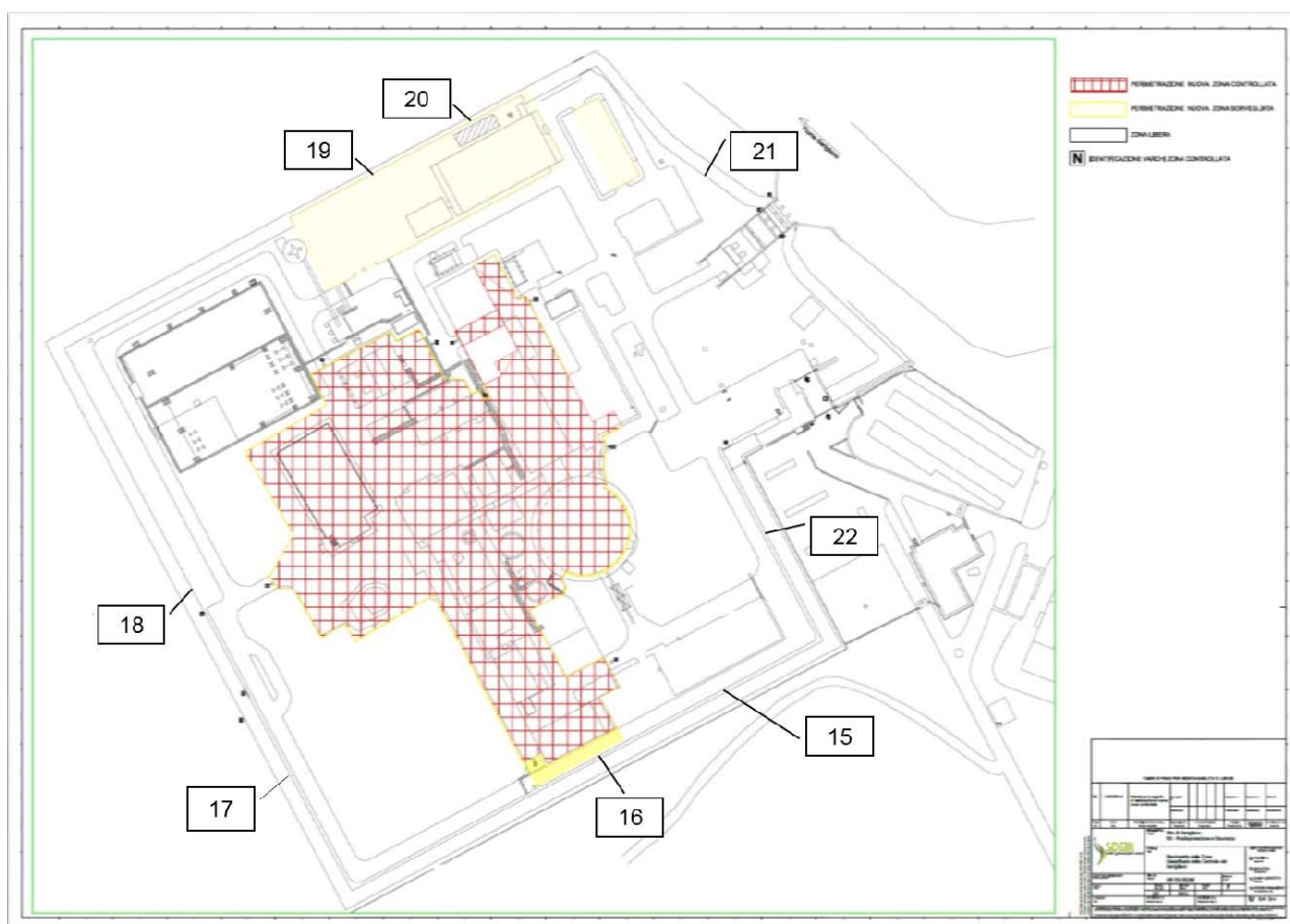
Figura 1 - Ubicazione dei dosimetri lungo la recinzione dell'Impianto
