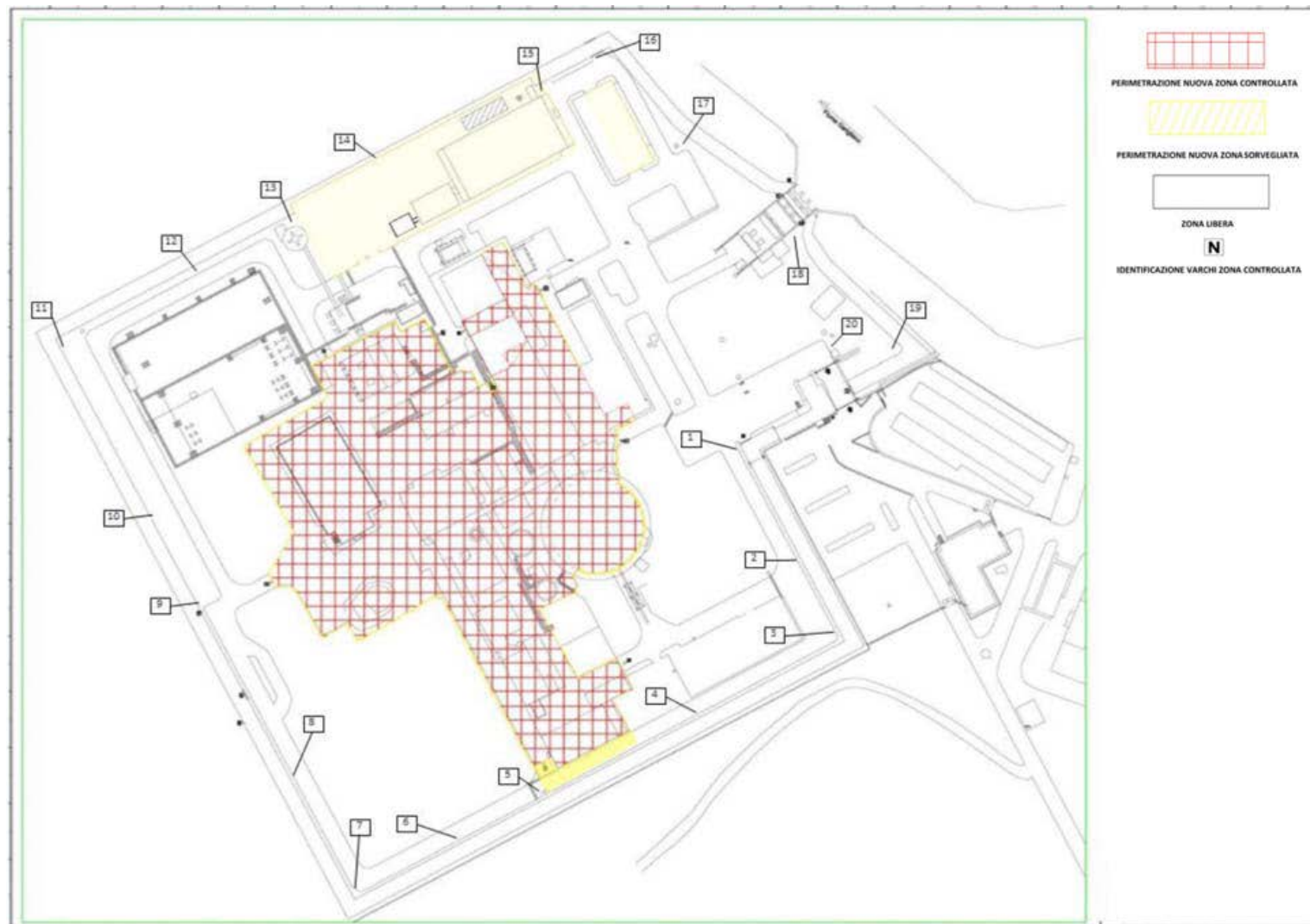
Figura 1 - Ubicazione dei dosimetri lungo la recinzione dell'Impianto
