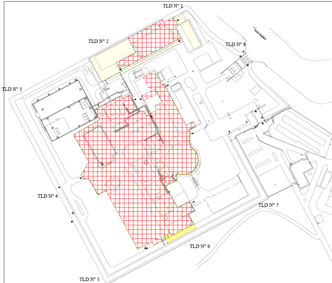
Figura 1 - Ubicazione dei dosimetri lungo la recinzione dell’impianto
